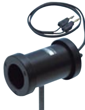
LEY450600 Lamphus på stativstång för optisk bänk. Sokkel: E14. Anslutning med 4 mm banankontakter.
