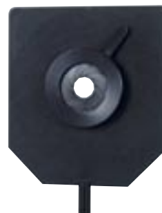
LEY461650 Irisbländare Kontinuerligt inställbar bländare av stål. Justerbar från ca 2-30 mm.
