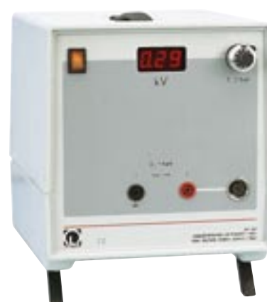
LEY521680 Högspänningsaggregat 1.5 kV Används som strömförsörjning till MCA box. Utspänning: 0–1,5 kV DC via 4 mm banankontakter. Max ström: 1 mA. Display: 2 1/2 siffror. Storlek: 20x21x 23 cm. Vikt: 2,5 kg.
