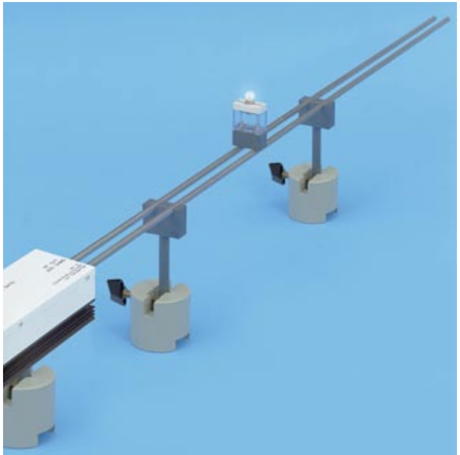
Bestämning av ström- och spänningsmaxima med Lecherutrustning
