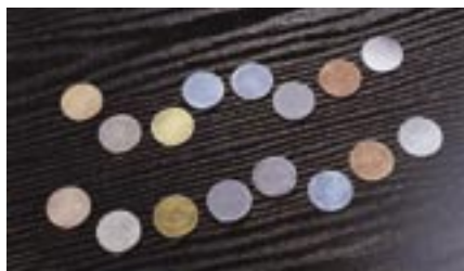
PHA473260 Metallskivor, olika material En sats med små metallskivor. Med hjälp av dessa kan man påvisa att en del metaller är magnetiska och andra omagnetiska. Skivorna kan även användas vid övningar för identifiering av olika metaller. Satsen innehåller 16 skivor med diametern 25 mm och alltid två av samma metall: rostfritt stål, mässing, zink, nickel, silver, brons, aluminium och koppar. På den ena skivan av varje par är metallens namn angivet; den andra skivan är utan namn.
