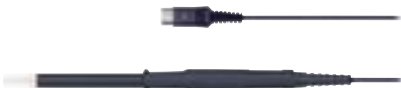
LEY529057 Luftfuktighet/Temperaturgivare Kombinerad givare för att registrera luftfuktighet samt temperatur. Ansluts till Sensor-CASSY via klimatbox LEY524057
