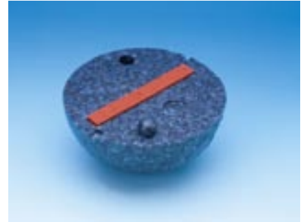
ISV240190 Modell av jordens magnetfält Åskådliggör jordens magnetfält. Med modellen kan skillnaden mellan den geografiska och magnetiska Nord- respektive Sydpolen studeras.
