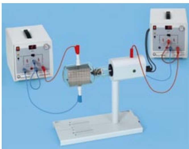
LEY521650 Spänningsaggregat 0-500 V Lämpligt aggregat för rören LEY55610 samt LEY555612. För ytterligare information se rubrik Strömförsörjning.
