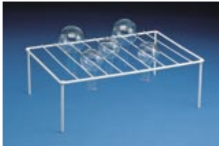
PHCOA61098 Torkställning för flaskor och E-kolvar Ställning av polyetenöverdragen stål med fyra ben. Galleravståndet är 44 mm. Upp till 1000 cm 3 flaskor kan torkas i ställningen. Storlek: 450x300x150 mm (LxBxH).
