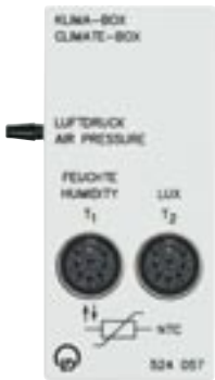
LEY524057 Klimatbox För registrering av luftfuktighet, temperatur (givare LEY529057), lufttryck och ljusstyrka (Lux givare LEY666243). Mätområden: Luftfuktighet: 0–100 % Temperatur: –40 °C...+80 °C Ljusstyrka: 0–200 klx Tryck: 800–1500 hPa
