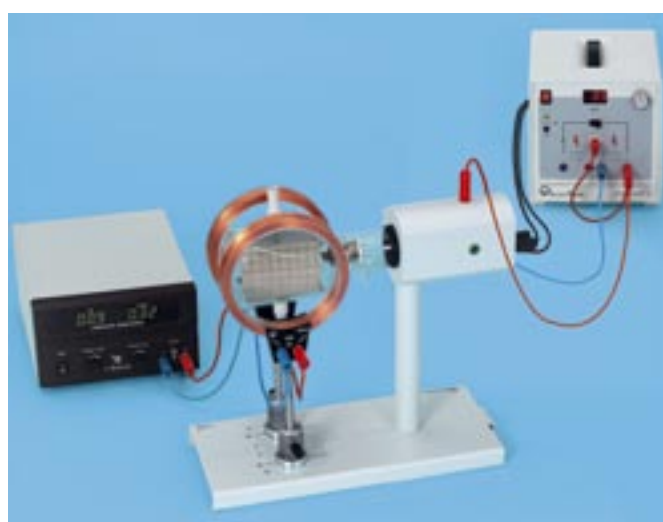
LEY555624 Avlänkningsrör i hållare Med detta rör påvisas elektronens rörelse i kastparabel i ett E-fält. Genom att använda Helmholtz spolar kan man få elektronerna att passera rakt fram i korsade E- och B-fält. Då elektroner går rakt fram kan hastigheten hos elektronerna bestämmas. Genom att variera accelerationsspänningen, E-fältspänningen samt strömmen genom Helmholtz spolar kan stimulerande fysikdiskussioner uppstå. Röret kräver två högspänningsaggregat upp till 10 kV vardera. B-fältet kräver spänningsaggregat upp till 30 V.
