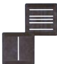
LEY461620 Spaltbländare – sats med 2 Spaltbredd: 1 mm. 5 spalter 1 spalt Passar i diaram LEY459330.
