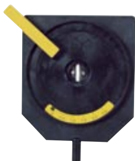
LEY471710 Justerbar spalt av stål För ex. försök inom geometrisk optik.
