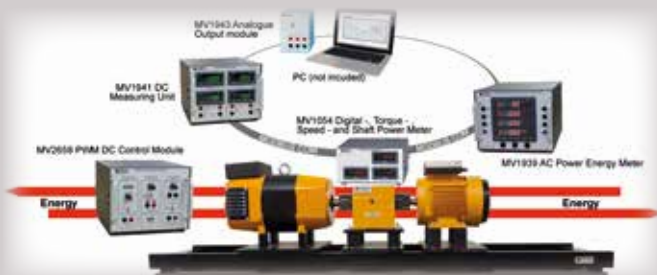
Elmaskiner och drivsystem
