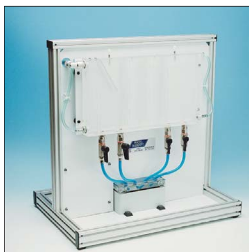
Tankmodellen används bl.a för reglering av nivå och flöde.
