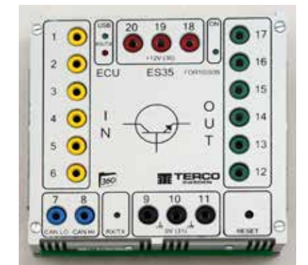
FOR102035 ES35 Styrenhet Kortet har: • 2 digitala ingångar 5V, 2 digitala utgångar 5V • 2 kraftutgångar 12V, 1A • 1 analog ingång, 1 analog utgång • USB-kontakt • Program och USB-kabel ingår
