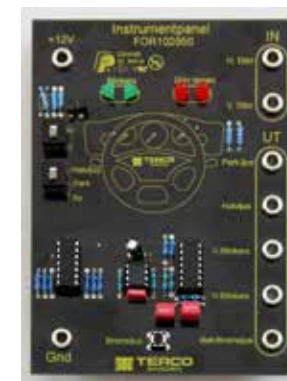
FOR102050 Instrumentpanel med simulering av belysning och dörrindikering. DIP-switch för felsimulering
