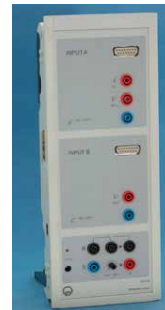
LEY524010SUBS CASSY-2 Start USB innehåller mätenhet och program. CASSY är ett datorbaserat mätinstrument för modern fordonselektronik. CASSY har två galvaniskt isolerade spänningsingångar för CAN-high och CAN low.
