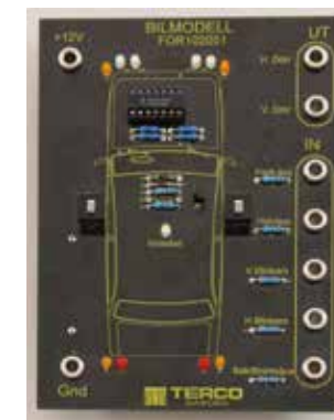
FOR102051 Bilmodell med indikeringar för belysning och switchar för simulering av dörrar. DIP-switch för felsimulering.
