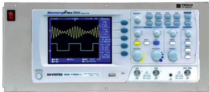
TF8031 Oscilloskop 2x100 MHz 25 G/s (GDS-1102a-U) monterad i inbyggnadsplåt.
